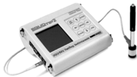
Obr. 2 Equotip 2 s rázovou jednotkou „D“
