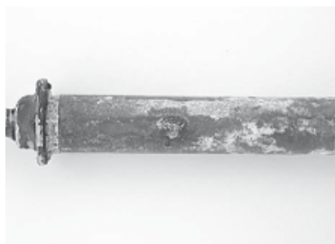
Obr. 11 Zokoušená austenitická korozivzdorná ocel legovaná molybdenem po 360 dnech ve zkarbonatovaném betonu se 3 hm.% Cl-/cem
