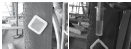
Obrázek 1 – Vyhodnocování čistoty povrchu – příprava výluhu Breslovou celou
