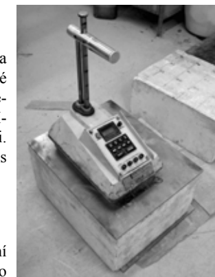
Obr. 2 Měření objemové vlhkosti aparaturou Troxler 3411 s osazenou ocelovou oblicovkou tloušťky 8 mm.
