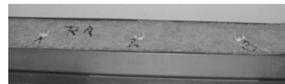
Obr. 3 Umístění měřících terčů na tělese vyrobeném v měřícím žlabu
