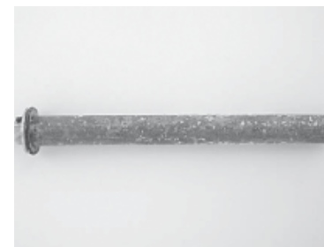
Obr. 13 Austenitická korozivzdorná ocel po 360 dnech ve zkarbonatovaném betonu se 3 hm.% Cl-/cem
