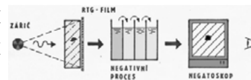
Obr. 5 Schéma radiografické kontroly vad v materiálu
