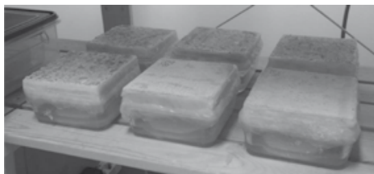
Obr. 3: Zkušební sestavy - uložení v klimatické komoře
