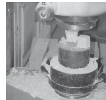
Obr. 2 Stanovení pevnosti v tlaku na normových trámečcích 40x40x160 mm
