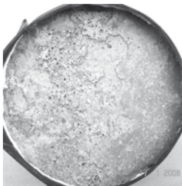
Obr. 5 – Ukázka zkoušené plochy po 25 cyklech met. C, kde příčinou vysokého odpadu je napěněná vrstva malty, převzato z /3/.
